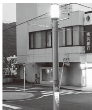
湯河原駅前通り明店街では、既設片側アーケードを撤去して街路灯を新設しました。商店街名を柱に表示してLED光源による投光照明です。近い将来、電線地中化されます
