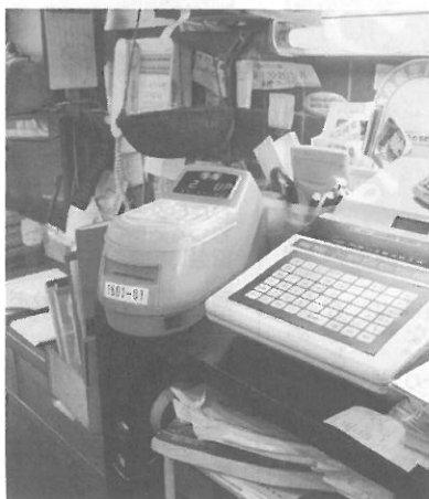
カードリーダーはこのようにレジ脇に置かれ、お客からあずかったカードに印字を行う
