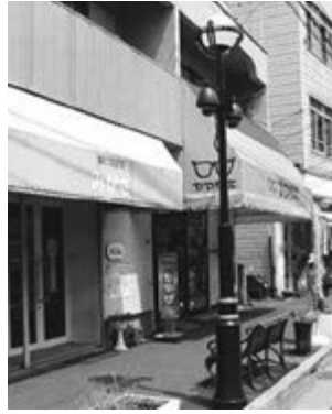
逗子市池田通り商店会では、電線地中化に伴う街路灯を新しくしました。安心安全のまちづくりで防犯カメラを街路灯に共架しています
